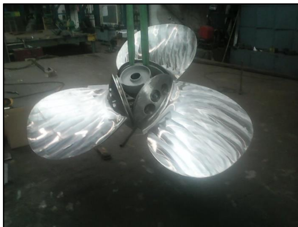
Reservepropellen reparert og nypussa.
