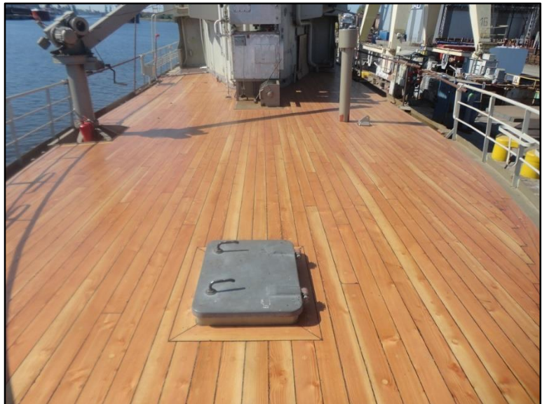
Nytt galgedekk ferdig lagt.
