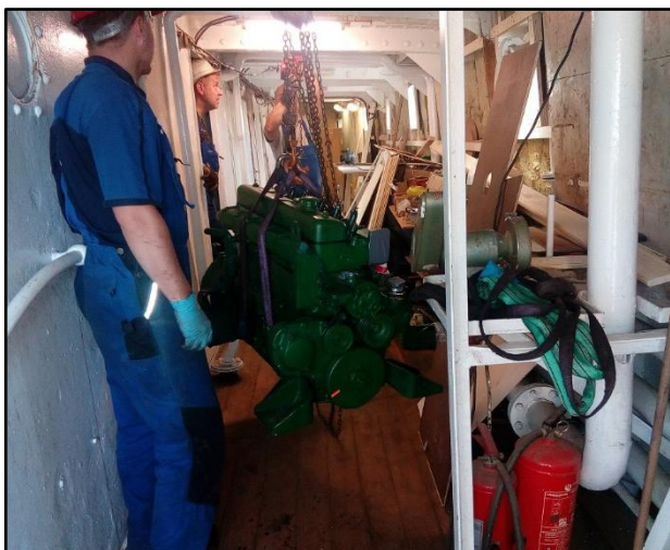
Den «nye» hjelpemotoren ved ankomst til verftet, (over) og under er den oppussa på veg ned i maskinrommet.
