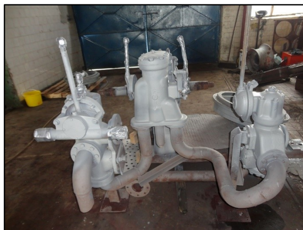
Hydraulisk utstyr til vinsj til overhaling, sandblåsing og maling.
