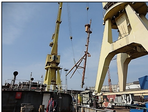
Masta på veg på land for sandblåsing og maling. Den vart lita i kroken på dei store kranene.
