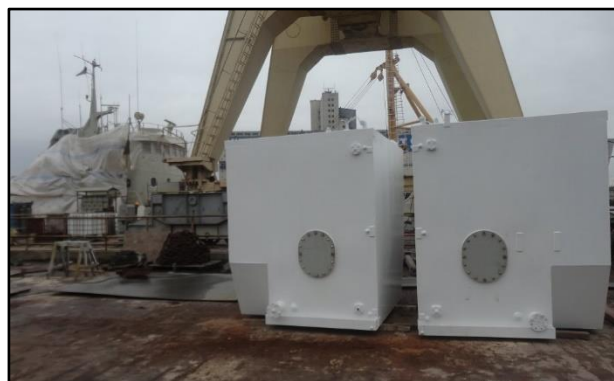
To av fire laustankar ferdig renover.
