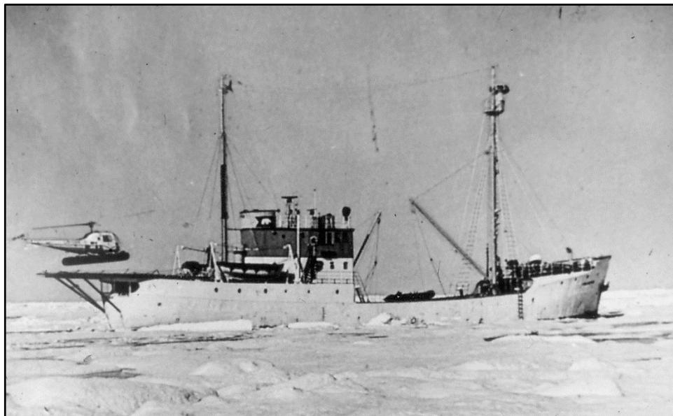
*Helikopter inn for landing på «Polarstar». Seinare vart bakmasta og stag fjerna for sikrare bruk av helikopter.*
